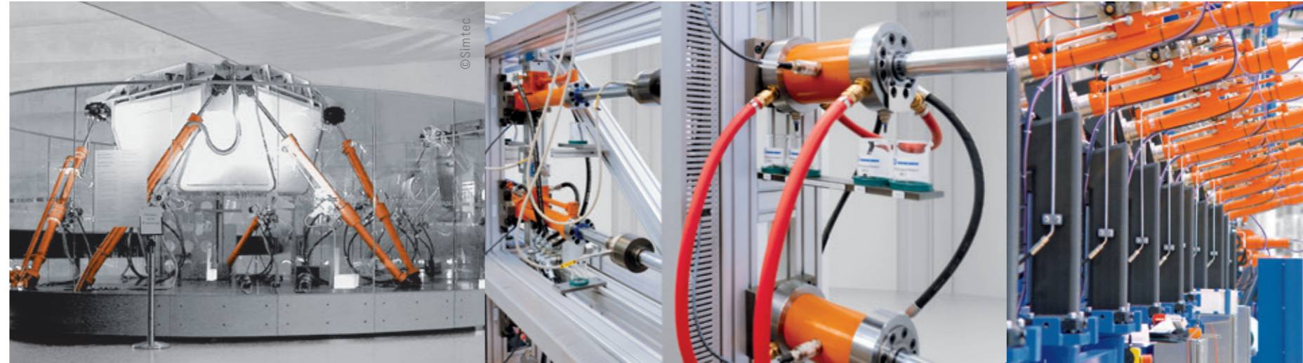
1 Hexapod: 模拟一段行驶路径 2 密封和杆件试验台: 确定摩擦力和泄漏 3 飞机机翼试验台: 着陆襟翼的环境条件的模拟
