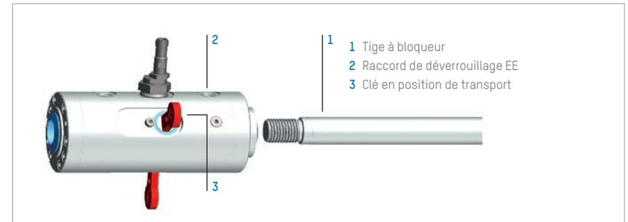
Illustration 13 : Installation du bloqueur de tige Ratio-Clamp® avec clé en position de transport
