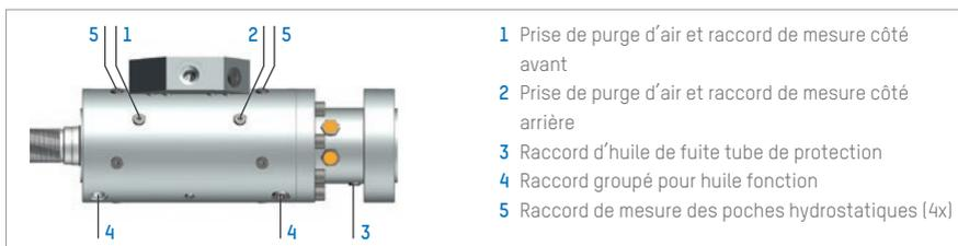
Illustration 7 : Prises de purge d'air et raccords de mesure du système de joints du vérin Servobear®
