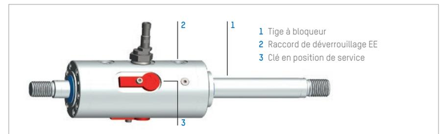
Illustration 14 : Installation du bloqueur de tige Ratio-Clamp® avec clé en position de service
