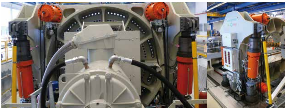
2 | Acht Hydraulik-Zylinder von Hänchen erbringen die Lasten und Momente wie sie unter realen Bedingungen in der Windkraftanlage herrschen.
