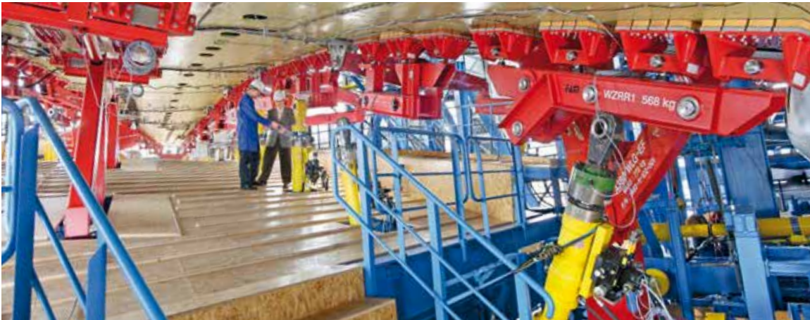
4 | Auch der Rumpf wird gezielt mit Hydraulikzylindern belastet.
