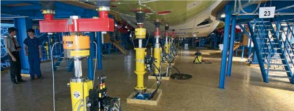
5 | Belastung des Rumpfs mit Hydraulikzylindern.
