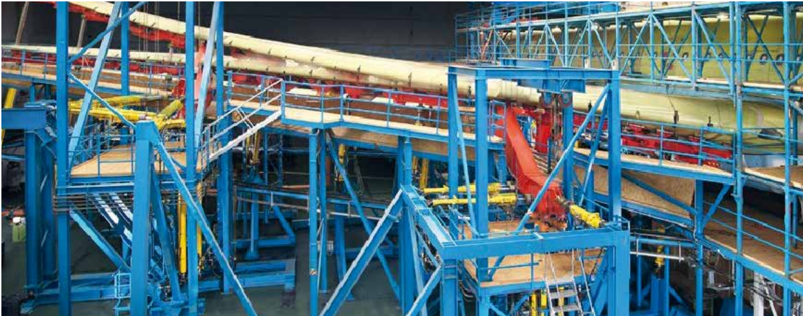
3 | Der Prüfstand: Sicht auf die Trag- flächen.
