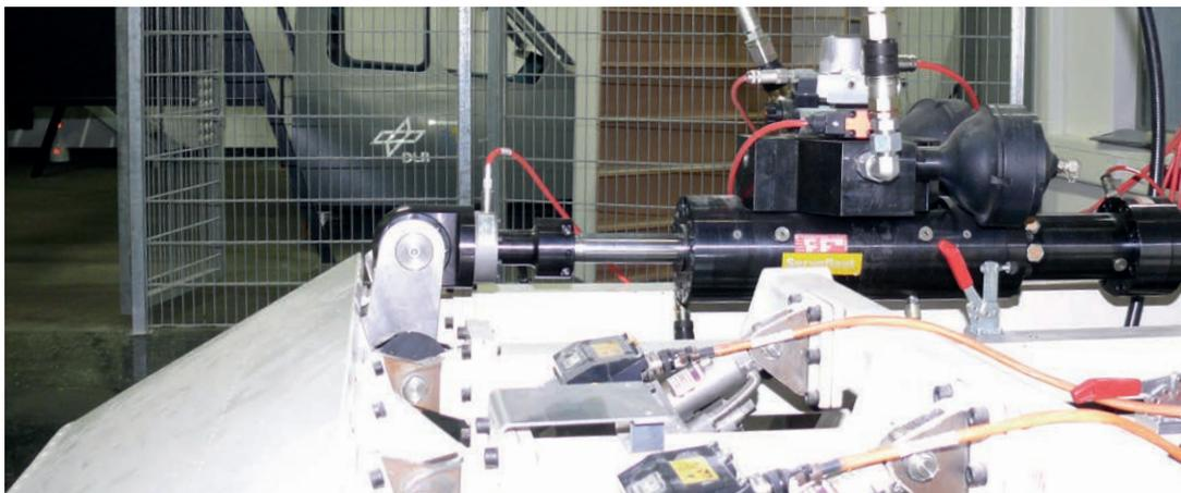
1 | Als Testumgebung dient dem DLR ein so genannter „Ironbird“, ein Prüfstand zur ganzheitlichen Betrachtung moderner Fly-by-wire-Systeme und deren Subsysteme.
